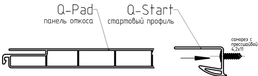
Шаг 2. Замерить глубину и высоту (ширину) проема как в плоскости стены, так и в плоскости окна. Подготовить и установить в стартовый профиль панели откоса.
