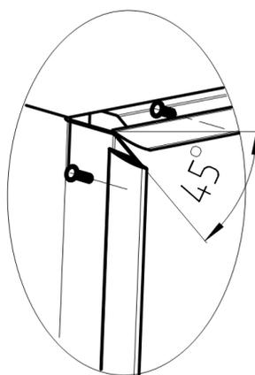
Шаг 1. Замерить, подрезать под углом 45° и установить стартовые профили. Шаг между саморезами 300-500 мм.
