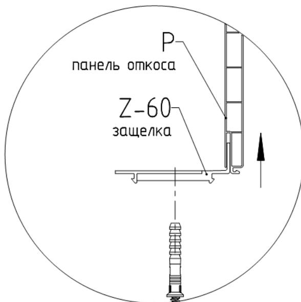
Шаг 4. Защелки завести в панели откоса и закрепить к стене с шагом 300-500мм.
